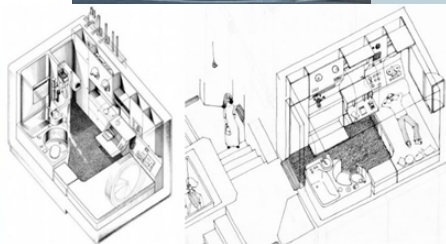
Gambar 3. Prinsip modul ukuran unit Apartement pada bangunan Nakagin Capsule Tower karya Kisho Kurokawa. Sumber : https://en.wikipedia.org/wiki/Nakagin_Capsule_Tower (akses tanggal : 1 September 2017)
