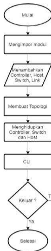
Gambar 4. Diagram alur membuat topologi di Mininet.
