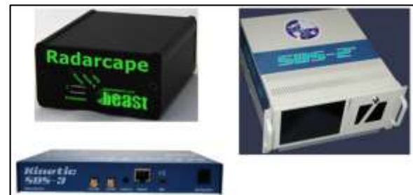
Gambar-3 : Tiga jenis ADS-B receiver yang dimiliki PTE-BPPT
