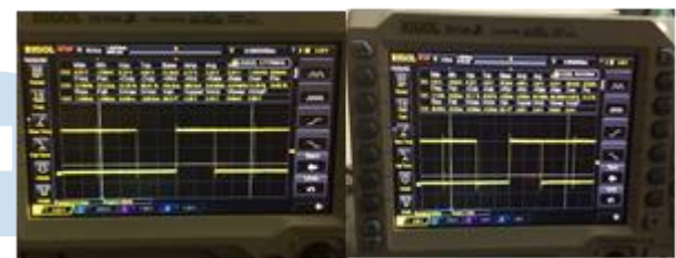
Gambar 6 Hasil Pengukuran Data Nilai Sensor pada Transmitter Menggunakan Osiloskop pada pengukuran Baudrate 9600bps dan 230400bps
