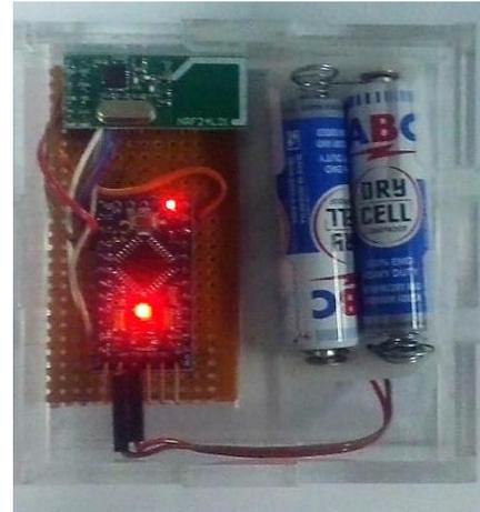
Gambar 3. Bentuk fisik dari node jaringan mesh nirkabel
