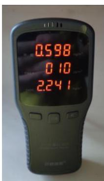
Gambar 8. Pengukuran VOC alkohol jarak 10cm
