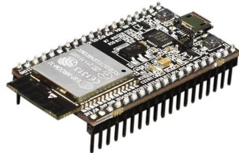
Gambar 5. Mikrokontroler ESP32
