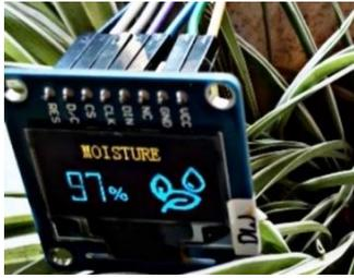
Gambar 10. Tampilan hasil Kelembaban Tanah pada layar LCD
