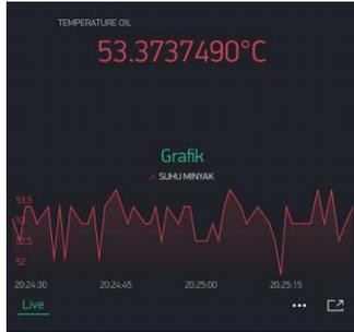
Gambar 5. Bentuk tampilan akuisisi temperature minyak pada aplikasi Blynk
