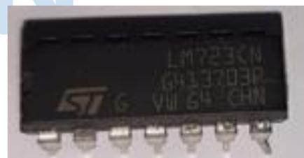
Gambar 3. Bentuk Fisik IC LM723
