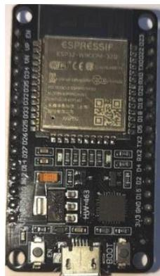
Gambar 1. Bentuk fisik Modul ESP 32
