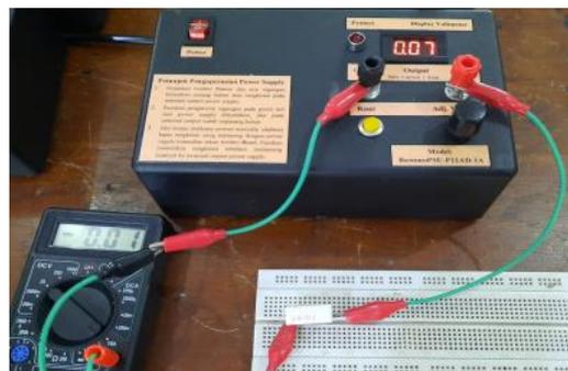
Gambar 12. Konfigurasi pengujian *power supply*
