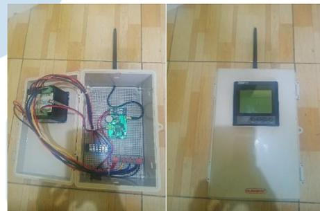
Gambar 4. Ilustrasi Perangkat kWh Meter 3 Fasa Berbasis IoT
