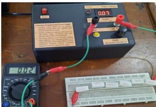
Gambar 14. Konfigurasi pengujian *power supply* pada beban 6 ohm.
