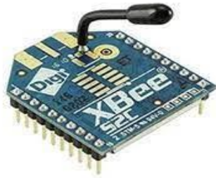
Fig. 4. XBee S2C module
